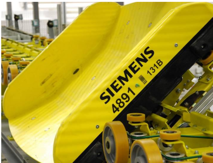
Der Tilt-Tray-Förderer leitet die Gepäckstücke über einen Gurtförderer auf Rutschen zur Übergabe an die Endstation für die Versorgung der Flugzeuge.
